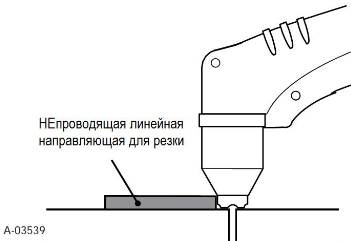
Использование колпака для резки волочением с направляющей
