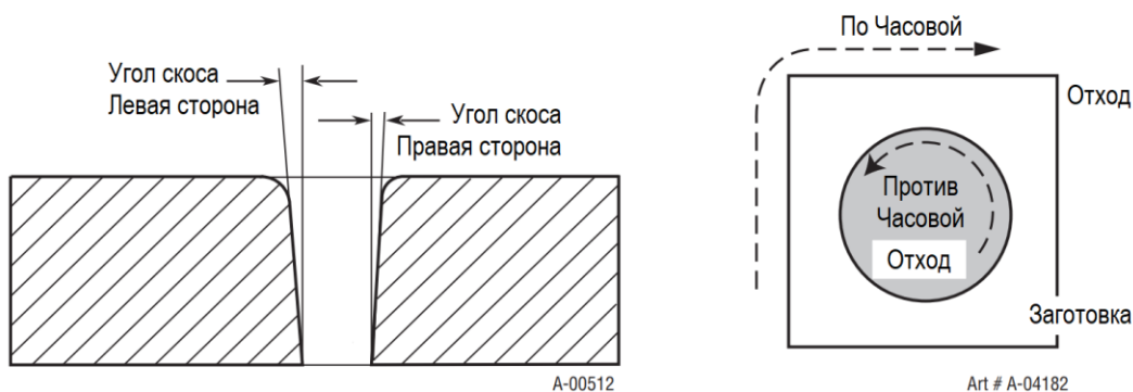
Влияние завихрения на характеристики сторон реза
